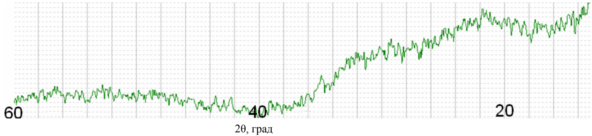
Рисунок 3.5 – Рентгенодифрактометрична картина отримана від порошку, який пройшов термічну обробку при температурі 200°C.
