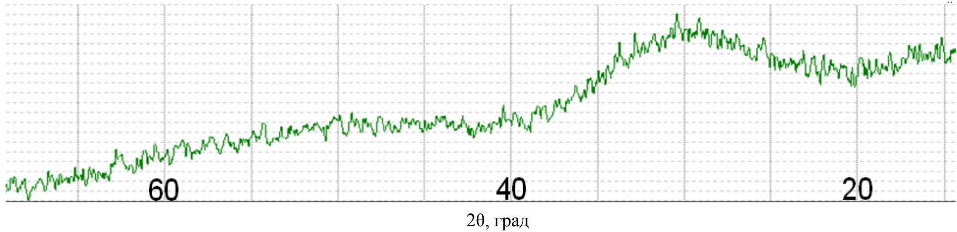
Рисунок 3.3 – Рентгенодифрактометрична картина отримана від осадженого та висушеного порошку
