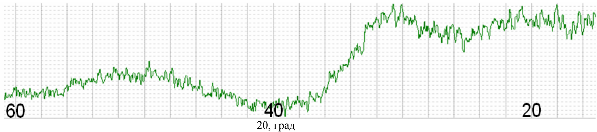
Рисунок 3.6 – Рентгенодифрактометрична картина отримана від порошку, який пройшов термічну обробку при температурі 300°C.
