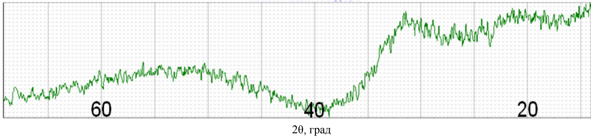
Рисунок 3.7 – Рентгенодифрактометрична картина отримана від порошку, який пройшов термічну обробку при температурі 400°C.
