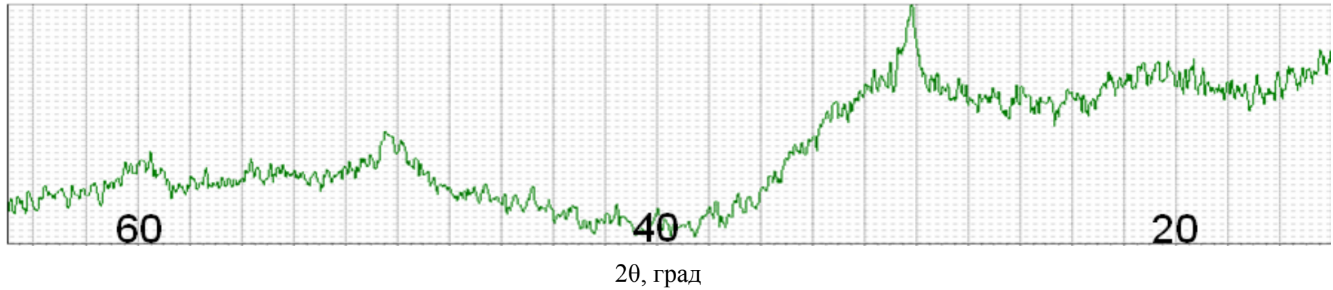
Рисунок 3.9 – Рентгенодифрактометрична картина отримана від порошку, який пройшов термічну обробку при температурі 600°C.
