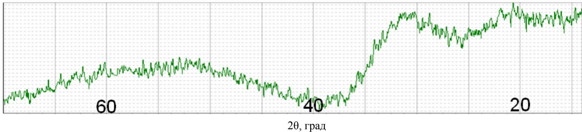
Рисунок 3.8 – Рентгенодифрактометрична картина отримана від порошку, який пройшов термічну обробку при температурі 500°C.
